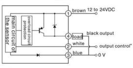
\*DARK-ON mode white ---12 to 24VDC LIGHT-ON mode ---0V
