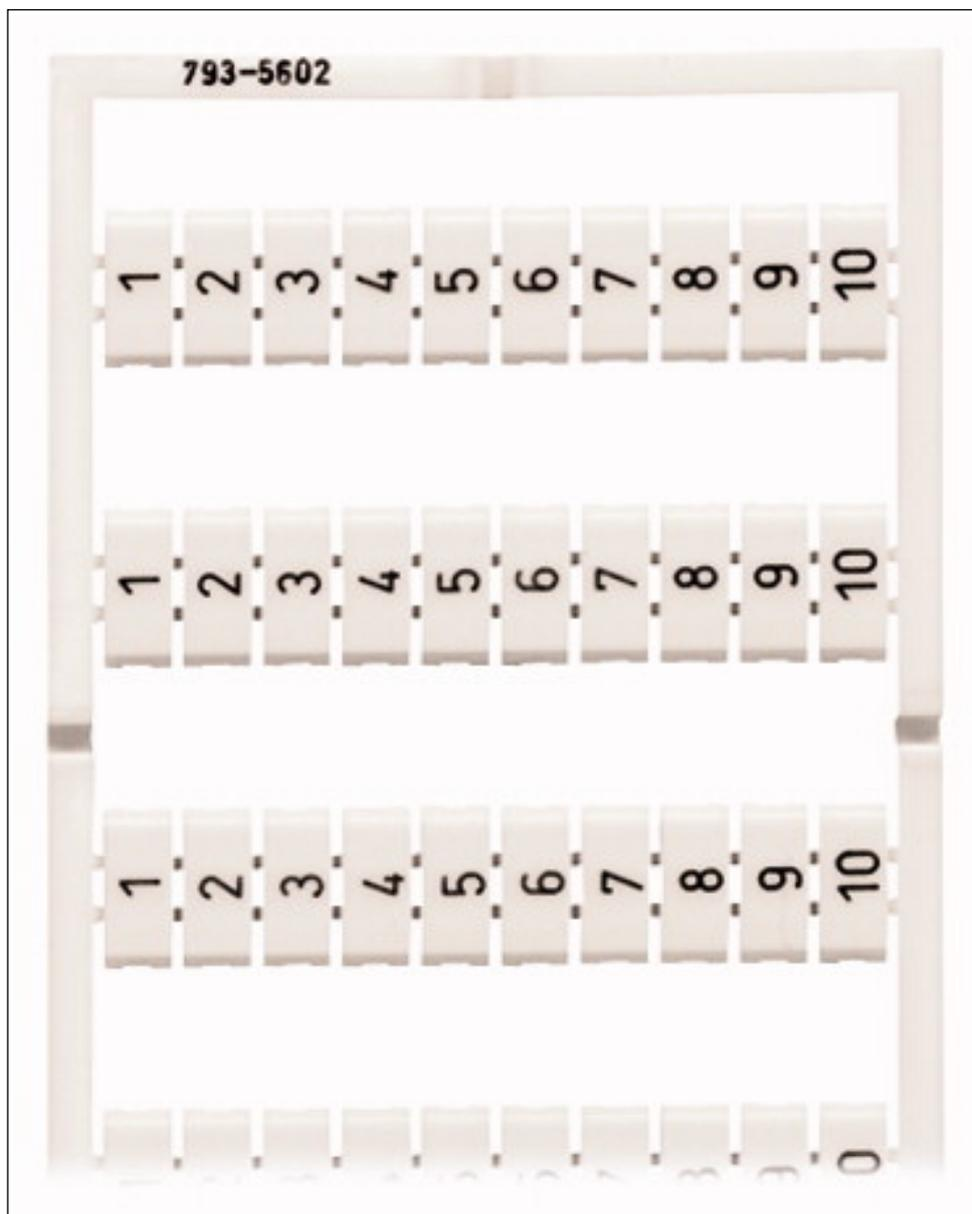
Druckansicht: WMB-Multibeschriftungssystem; Aufdruck senkrecht; 1 ... 10 (10x); für Klemmenbreite 5 - 17,5 mm; dehnbar 5 - 5,2 mm; 10 Streifen à 10 Schilder pro Karte; Fortlaufende Ziffern je Streifen -
