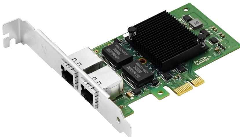
LREC9222HT 是深圳市联瑞电子有限公司在基于 Intel I350 芯片方案基础上而自主研发的一款 PCI Express x1 双电口千兆以太网网络适配器，该卡同时兼容在 PCIe x4、x8、x16 通道上使用。该款适配器能够通过多个端口同时捆绑汇聚成组，以实现容错与冗余用来扩展网络带宽及保障网络性能，能够实时自动检测并实现将来自故障端口的通信路由至同组中其他成员继续运行，以实现不间断高性能通信。
