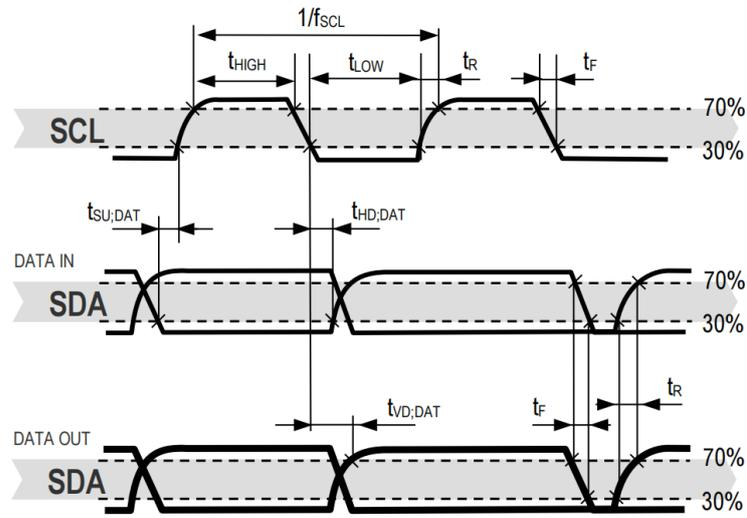
注：SDA 方向是以传感器芯片端为参考。加粗的 SDA 是由传感器控制，普通的 SDA 线由上位机控制。
