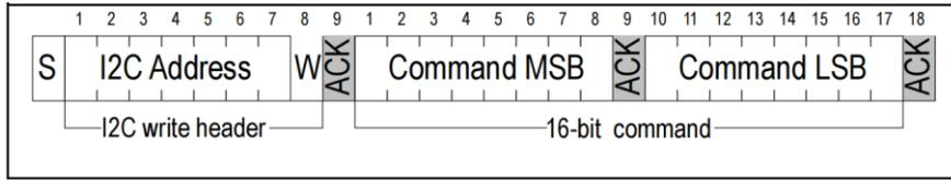
注：白色框由上位机控制，灰色框由传感器芯片控制。最高转换频率可能会引起芯片的自发热问题。
