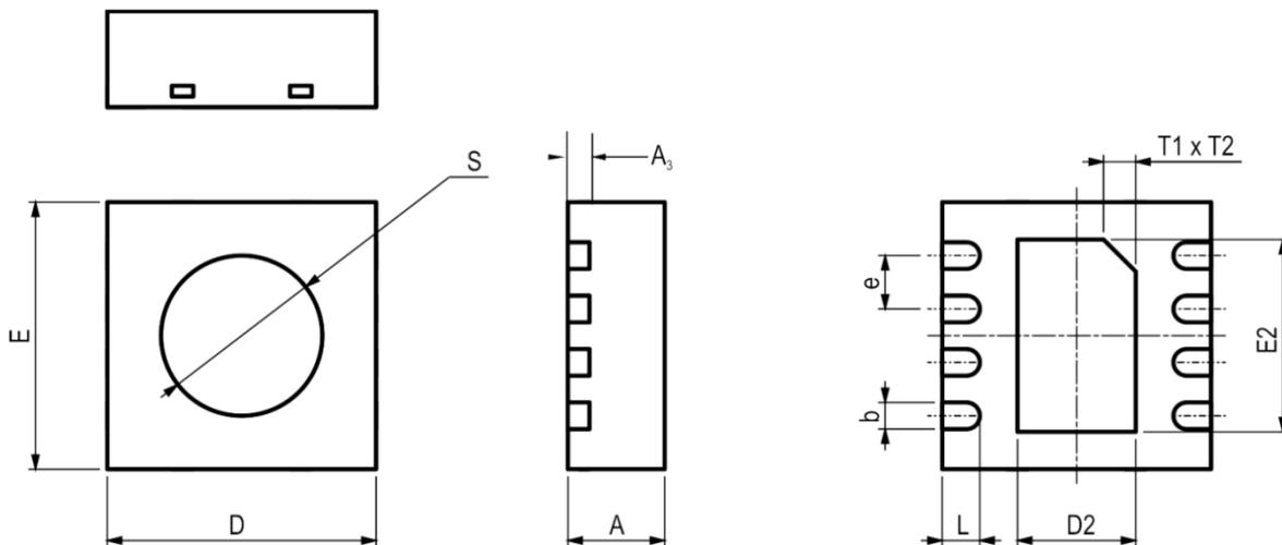
图 8 GXHT31 传感器封装尺寸
