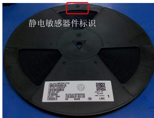
13英寸卷盘标签张贴及QA印章位置
