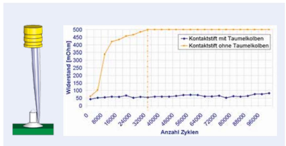
Die Auslenkung des Taumelkolbens geht weit über die Funktion der flexiblen Nadel hinaus. Der spezielle Aufbau des Kolbens ermöglicht starke Auslenkungen ohne nennenswerte Materialabnutzung. Ein Extremtest mit Kolbenauslenkung bis 0,8 mm ergab eine herausragende elektrische Performance und Lebensdauer. Das Diagramm zeigt den Vergleich mit einem herkömmlichen Stift ohne Taumelkolben.
