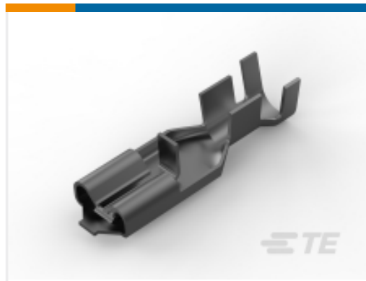
TE Part # 170335-1 PL 250 RECEPTACLE 15-10 AWG PTPBR
