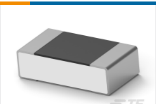
TE 产品编号6-2176371-3 RQ 0603 20K5 0.1% 10PPM 5K RL
