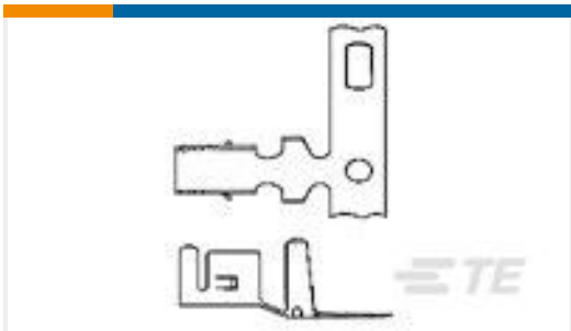
TE Part #3-770060-1 MINI AMP-IN PTLP/PHBZ
