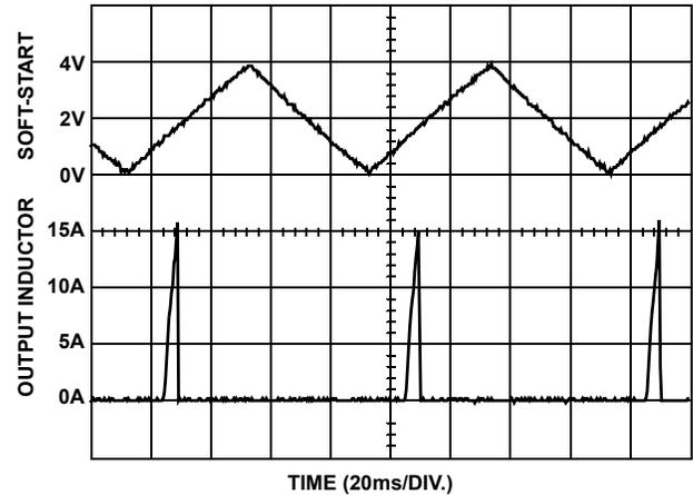
FIGURE 4. OVER-CURRENT OPERATION
