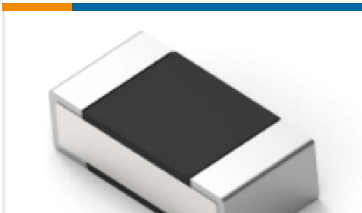
TE Part #9-2176305-5 RP 1E 0.1W 1K02 0.1% 25PPM 5K RL
