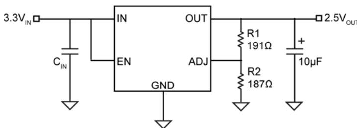
$$V_{\text{OUT}} = 1.242 \times \left( \frac{R1}{R2} + 1 \right)$$
