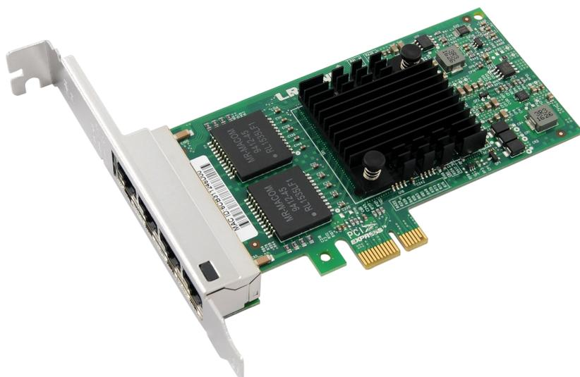
LREC9224PT 是深圳市联瑞电子有限公司自主研发的一款基于 Intel I350 芯片的四口千兆 PCIe x1 以太网网络适配器。该卡兼容 PCIe X4、X8 和 X16 插槽。LREC9224PT 设计主要应用于桌面工作站，通过四端口同时分组捆绑在一起，以实现容错和冗余，用于扩展网络带宽和保证网络性能，可以实现实时性自动检测故障端口并将来自组内其他成员的通信路由继续运行，以实现持续的高性能通信。
