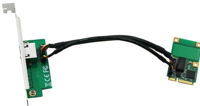
LRES2206PT 是深圳市联瑞电子有限公司在基于 Intel I210 方案基础上而自主研发的一款 Mini PCIe x1 全高 ( 半高 ) 单电口千兆以太网网络适配器。该款适配卡采用了 Mini PCI-e 插槽设计, 旨在用于工控机、单板机等含有 Mini PCIe 接口插槽的工业设备上使用, 可以极大解决设备空间紧凑问题, 该款以太网适配卡支持 10/100/1000Mbps 的自适应链接速率网络中, 实现在工业现场数据传输。
