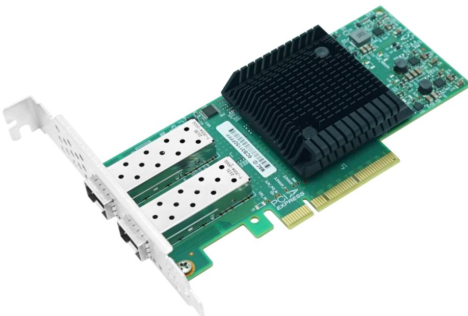
LRES1026PF-2SFP28 是深圳市联瑞电子有限公司在基于 Mellanox ConnectX-4 主控方案上开发的一款 PCIe v3.0 x8 双口光纤 25G 以太网网络适配器。支持 1/10/25G 三种速率连接以满足于当前网络设施的虚拟化应用。
