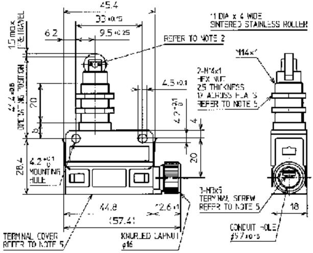
NOTES 1 SWITCH ENCLOSURE SIGN ZING ALLOY LOATED WITH BLACK PLUGROPLASTICS TERMINAL COVER IS PLASTIC.
