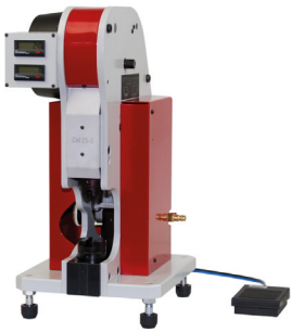
WA10672 气动压接工具 紧凑免维护台式工具，适用于高 达 25 kN 的压力，工作压力 6 bar。手或脚控开关。 没有任何压接插接件的交付。 Pneumatic Crimp Tool Compact maintenance-free table tool for pressure force up to 25 kN, operating pressure 6 bar. Hand- or foot-operated switch. Delivery without any crimping inserts.
