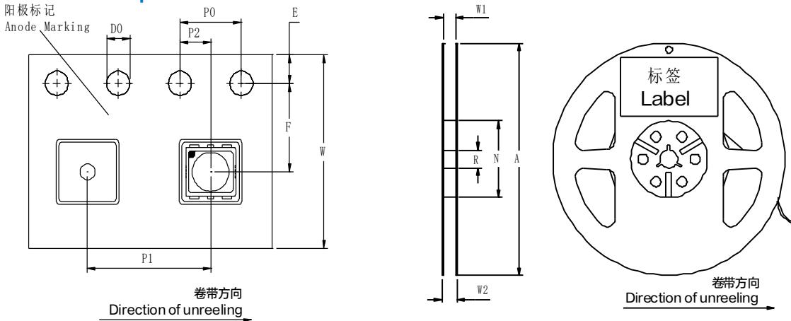
前端空带: 最小400 mm; 尾端空带: 最小160 mm; 尺寸符合: IEC 60286-3, EIA 481-D
