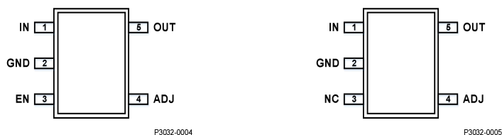
图4.3 SOT23-5封装 注2 (2.92mm×2.8mm×1.1mm)
