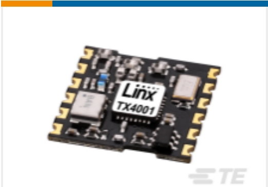
TE Part #TRM-433-LT Module LT 433MHz AM OOK XCVR
