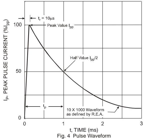
Fig. 4 Pulse Waveform
