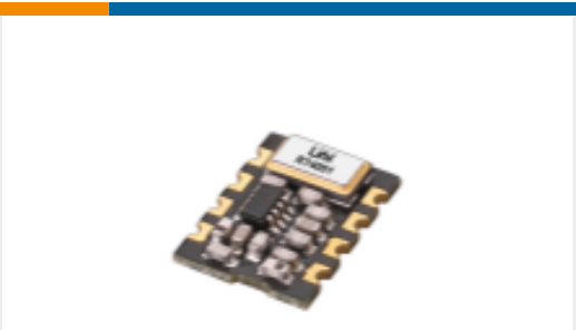
TE Part #TXM-433-LR Module LR 433MHz AM OOK TX XMTR
