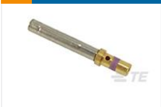
TE Part #0462-005-2031 SOC, SOLID, SIZE 20, 16-18AWG, AU
