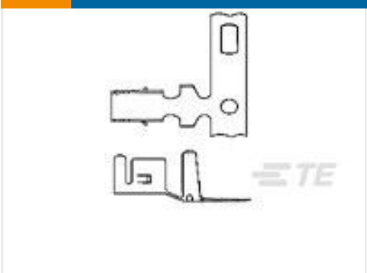
TE Part #3-794037-1 MINI AMP-IN PTP PHBZ 10AWG
