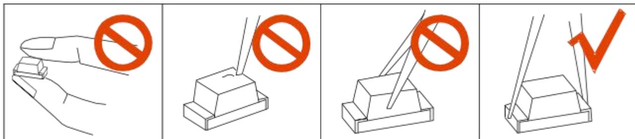
\*LED 的环氧树脂封装部分相当脆弱，请勿用坚硬、尖锐的物体刮、擦封装树脂部分。在用镊子夹取的时候也应当小心注意。
