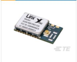
TE Part #HUM-900-PRC-CAS Module HUM-PRC 900MHz FHSS FM XCVR FCC
