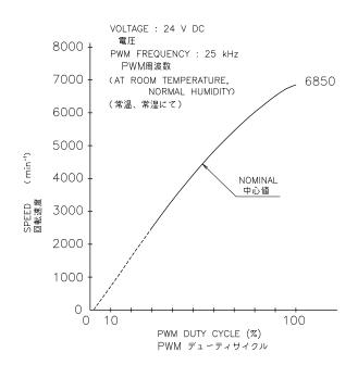
NOTE:1. WHEN PWM DUTY CYCLE IS 0%, THE SPEED IS 0 min<sup>-1</sup>. 注 PWMデューティサイクルが 0%の時、回転速度は0min<sup>-1</sup>のこと。
