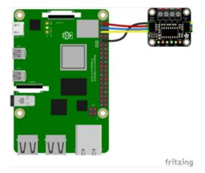
Pi 3V to ADC VIN (red wire)
