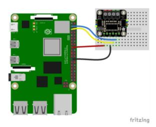
Pi 3V to ADC VIN (red wire)
