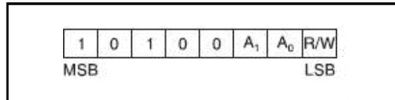
**Figure 5. Byte Write**
