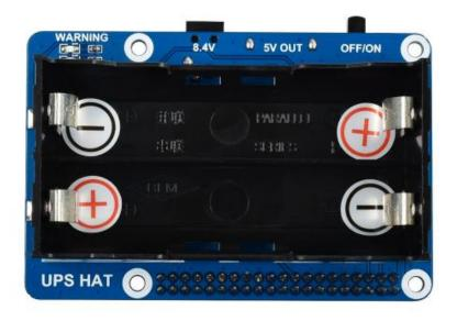
8.4V 接口为充电接口,使用 8.4V 2A 电源充电。5V OUT 为 USB 母口,可输出 5V 电源。0FF/ON 丝印为电源开关丝印。
