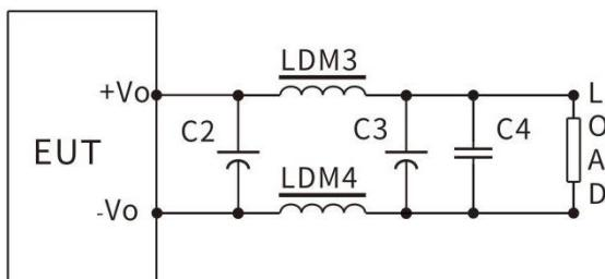
对纹波&噪声要求一般时，外围推荐仅使用 C2 即可；对纹波&噪声要求严格时；推荐使用上图电路。
