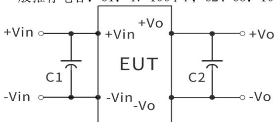
纹波&噪声测试: (双绞线法 20MHZ 带宽)
