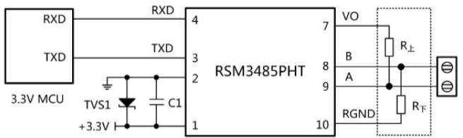
图 2.MCU 3.3V 供电应用电路
