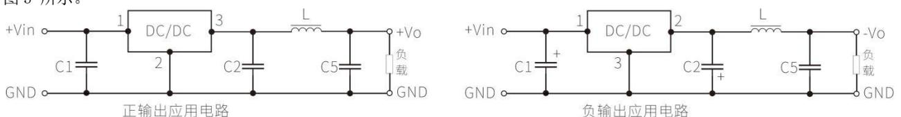
图3 'LC' 滤波应用电路
