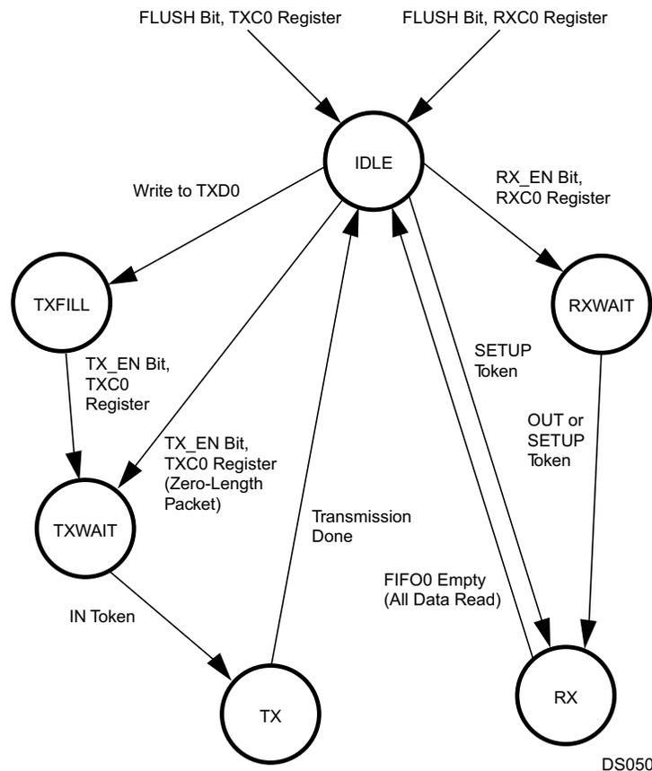
**Figure 18-2. Endpoint 0 Operation**
