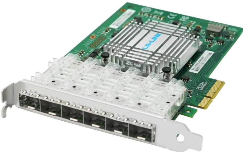
LRES1006PF-6SFP 是深圳市联瑞电子有限公司在基于 Intel I350 主控方案上自主研发的一款 PCI Express x4 六光口千兆 SFP 以太网网络适配器；该款适配卡能够通过捆绑汇聚成组实现容错，自动检测并实现将来自故障端口的通信路由至同组中其他成员继续运行以实现不间断通信。该适配卡具有集成的硬件加速功能，能够执行 TCP/UDP/IP 校验和分载及 TCP 分段任务。主机处理技术可分载加速器，释放 CPU 资源的占用，以腾出更多的 CPU 资源来处理其他应用程序。该适配卡是部署多个网络以及在高性能服务器上部署关键网络应用和环境的理想解决方案。
