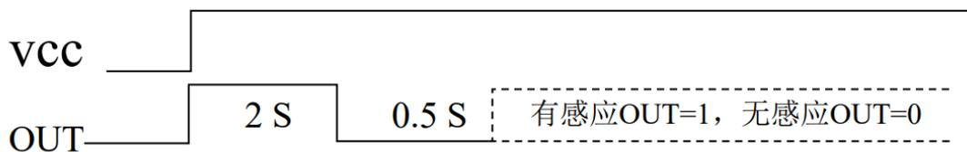
图 4 模块上电时序图
