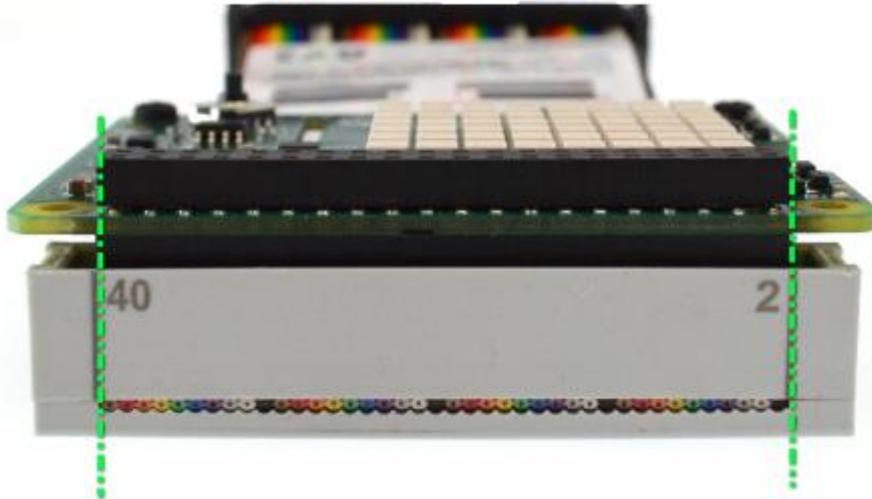
C. 在接通 Pi400 的电源之前，请根据下表仔细检查拓展模块的方向以及针脚 1,2 和 40 的位置。
