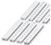
快速标记条，接头，白色，标识，适用的打印机：CMS-P1-PLOTTER，横向打印: 连续编号1 - 10、11 - 20等，直至491 - 500，安装方式: 卡接到高型标记槽，适用的模块宽度：8.2 mm，标识区域大小: 10.5 x 8.15 mm
