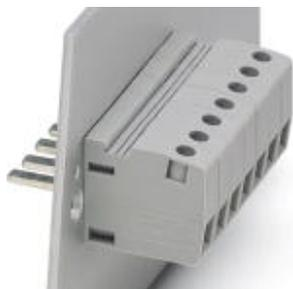
Durchführungsklemme, 接线方式: 螺钉连接, 焊接, 位数: 1, 负载电流: 63 A, 横截面: 0.5 mm<sup>2</sup> - 16 mm<sup>2</sup>, AWG 20 - 6, 导线连接方向与拔插方向的夹角: 0°, 宽度: 10.1 mm, 颜色: 灰色
