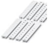
用于端子的标记条，接头，白色，标识，横向打印: 连续编号1 - 9，安装方式: 卡接到高型标记槽，适用的模块宽度：8.2 mm，标识区域大小: 10.5 x 8.15 mm
