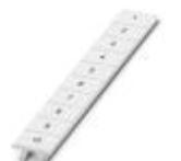
快速标记条，接头，白色，标识，适用的打印机：CMS-P1-PLOTTER，纵向打印: 连续编号1 - 10、11 - 20等，直至91 - 100，安装方式: 卡接到高型标记槽，适用的模块宽度：8.2 mm，标识区域大小: 10.5 x 8.15 mm
