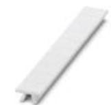
快速标记条，接头，白色，未标记，适用的打印机：CMS-P1-PLOTTER，PLOTMARK，安装方式: 卡接到高型标记槽，适用的模块宽度：8.2 mm，标识区域大小: 10.5 x 8.15 mm
