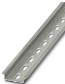
DIN导轨，有孔，标准配置，宽度: 35 mm，高度: 7.5 mm，符合EN 60715标准，标识材料: 钢，无镀层，长度: 2000 mm，颜色: 铝白色
