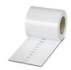
用于端子的标记条, 盘卷, 白色, 未标记, THERMOMARK ROLL, THERMOMARK ROLL X1, THERMOMARK ROLLMASTER 300/600, THERMOMARK X1.2, 打孔, 安装方式: 卡接到通用的标记槽, 卡接到扁平式标记槽, 适用的模块宽度: 5.2 mm, 标识区域大小: 6.4 x 5.15 mm
