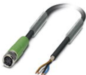
传感器/执行器电缆，4-芯，PUR 无卤素，黑-灰色 RAL 7021，屏蔽，端自由出线，与 孔式 直头 M8，电缆长度: 15 m
