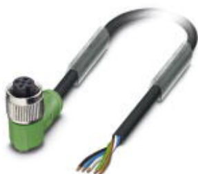
传感器/执行器电缆，5-芯，PUR 无卤素，黑-灰色 RAL 7021，端自由出线，与 孔式 弯头 M12，A 编码，电缆长度: 15 m
