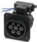
充电装置插座出口，用于以交流电 (AC) 为电动车辆充电，与充电装置插头兼容，2类，IEC 62196-2，32 A / 480 V (AC)，24 V 锁定执行器，芯线数，长度: 0.7 m，板后安装，铰接盖的螺钉连接: 只可以后部安装
