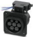
充电装置插座出口，用于以交流电 (AC) 为电动车辆充电，与充电装置插头兼容，2类，IEC 62196-2，32 A / 480 V (AC)，12 V 锁定执行器，芯线数，长度: 0.7 m，板后安装，铰接盖的螺钉连接: 只可以后部安装
