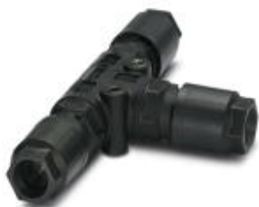
QUICKON T型分配器，黑色，4+PE位，1.0 mm 2 ... 2.5 mm 2 /690 V/20 A，用于直径9 mm ... 16 mm的电缆，带三个QUICKON螺母
