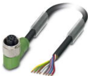
M12孔式，弯头，8芯，预制主电缆，用于带M8插槽的传感器/执行器分线盒，电缆长度：5 m
