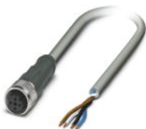
传感器/执行器电缆，4-芯，端自由出线，与孔式直头 M12，A编码，电缆长度: 10 m
