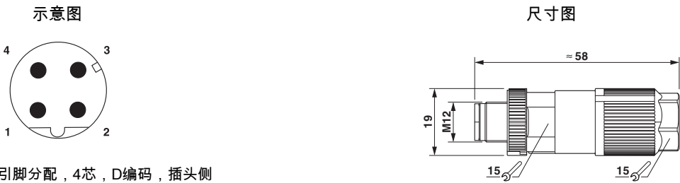
M12针式连接器引脚分配，4芯，D编码，插头侧
