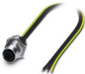
针式插座，电源，3-芯，孔式，M12，S电源，板后安装，M16 x 1.5，单线，电缆长度: 0.5 m
