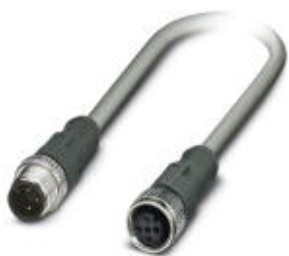
传感器/执行器电缆，3-芯，插头 直头 M12，A编码，与 孔式 直头 M12，A编码，电缆长度: 2 m
