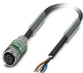
传感器/执行器电缆，4-芯，PVC，黑色 RAL 9005，端自由出线，与 孔式 直头 M12，A编码，与 2个LED，电缆长度: 5 m
